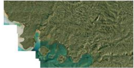
Orthophotos aériennes (photo aérienne qui corrige les déformations liées à la rotondité de la Terre, à l'inclinaison des prises de vues et au relief du terrain)
