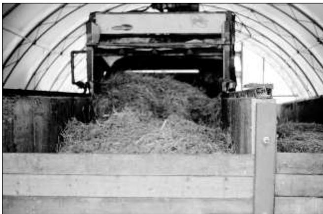
Figure 3: Petit système de compostage en contenants avec retourneur dans un canal.
